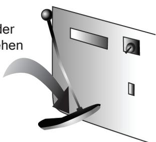
5. Drücken Sie das Pedal nach vorne oder nach hinten, um die Drehzahl zu erhöhen bzw. zu reduzieren. Zum Anhalten des Scheibenkopfs ist das Pedal vollkommen nach hinten zu drücken.
